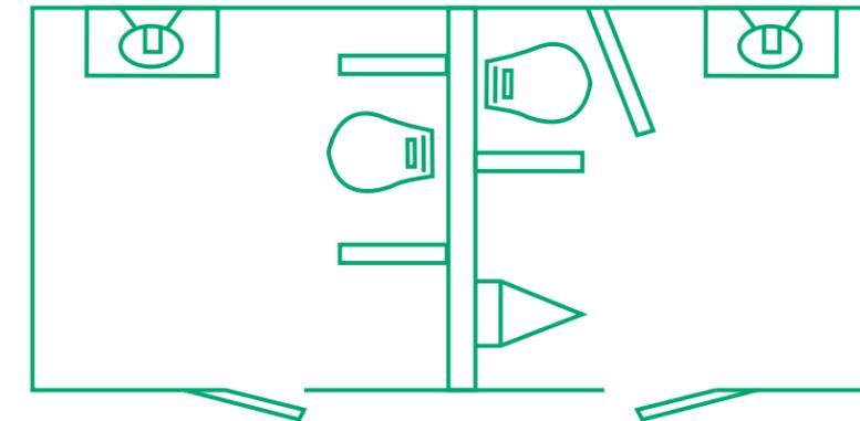
El espacio está dividido en dos secciones con entradas y salidas independientes. Una sección con un WC y un urinario para varones, y la segunda sección con un WC privado para damas.
